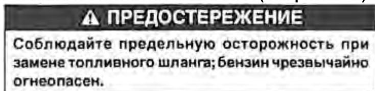
Заменяйте топливный шланг каждые 2 года. В случае утечки топлива из топливного шланга замените топливный шланг немедленно.
