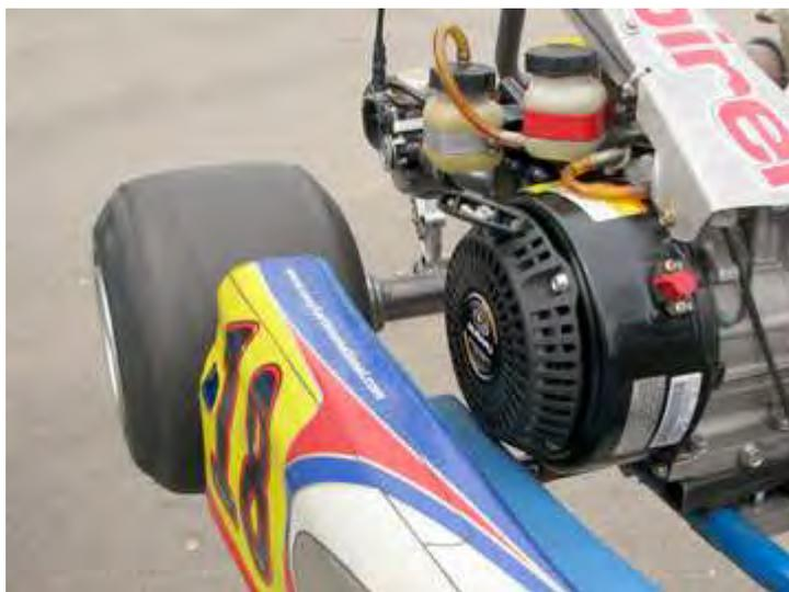
Новый картинговый двигатель **SUBARU KX21** разработан с учетом требований спортивных картов и обладает высокой мощностью. Основой данного двигателя стал бензиновый двигатель серии **EX** – воздушного охлаждения, 4-тактный, с верхним расположением распредвала. Прогрессивные технологии **SUBARU** позволили сочетать оптимальный дизайн с преимуществом системы верхнего расположения распредвала двигателя.
